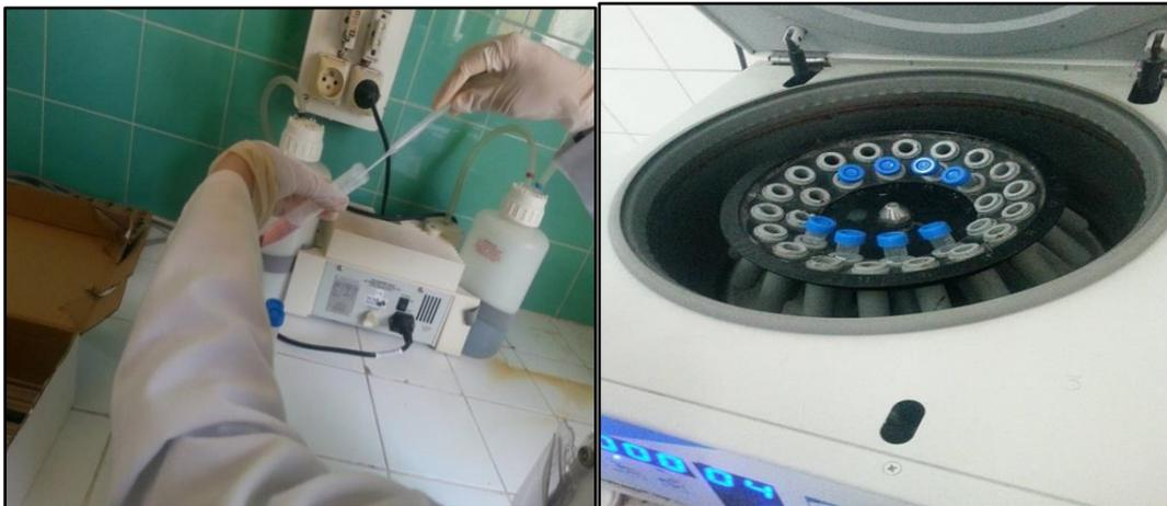
**Figure 14** : Aspiration de surnageant après centrifugation à 1500 tours / mn pendant 5mn.
