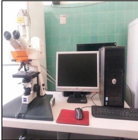
**Figure 15 :** Microscope optique couplé à une caméra numérique de haute résolution de capture ainsi qu'un logiciel d'analyse.
