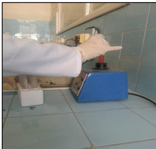
**Figure 13:** Eclatement des cellules à l'aide d'un vortex.
